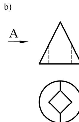
7. Să se reprezinte cele șase proiecții ale piesei reprezentată axonometric, după metoda europeană de proiecție. Proiecția principală a piesei se va alege în funcție de direcția indicată **A**. Dimensiunile piesei se vor alege constructiv în așa fel să fie încadrate în cubul de proiecție desfășurat mai jos.
